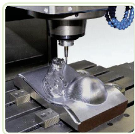
**Figura 5.18: Usinagem de uma peça em um centro de usinagem vertical**
