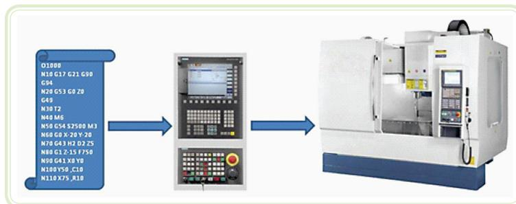
**Figura 5.1: Componentes básicos de um sistema NC**
