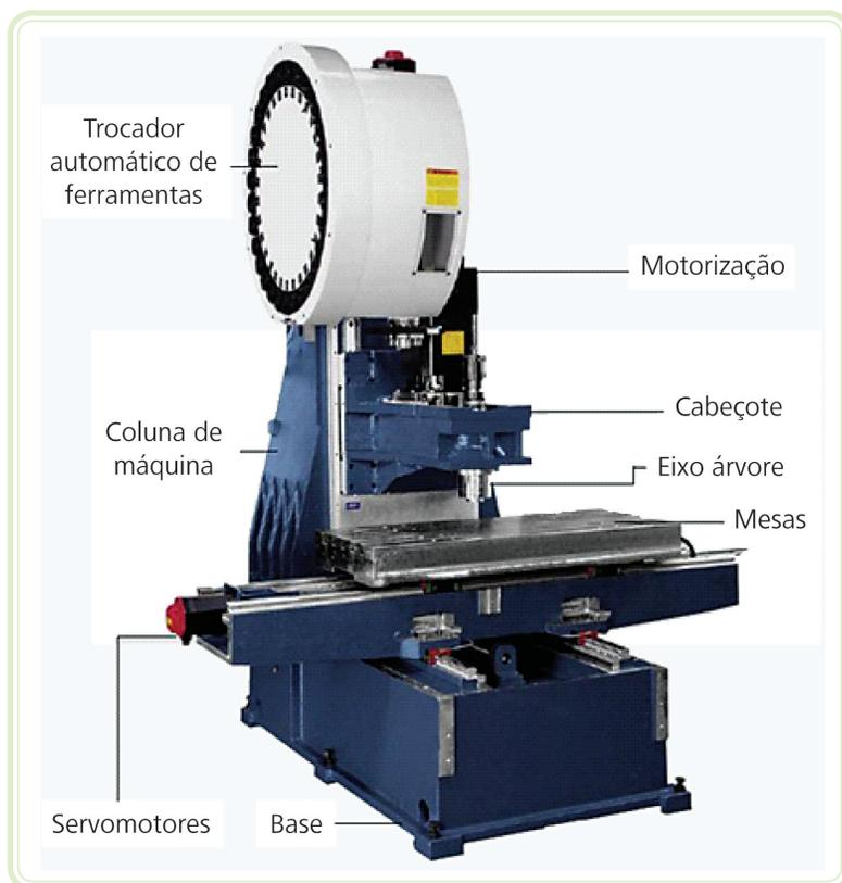
**Figura 5.6: Estrutura e componentes de um centro de usinagem CNC**
