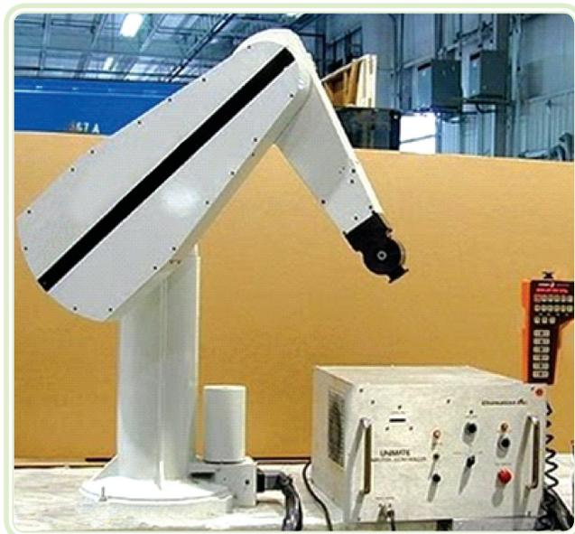
**Figura 3.2: Robô PUMA com seu controlador**
