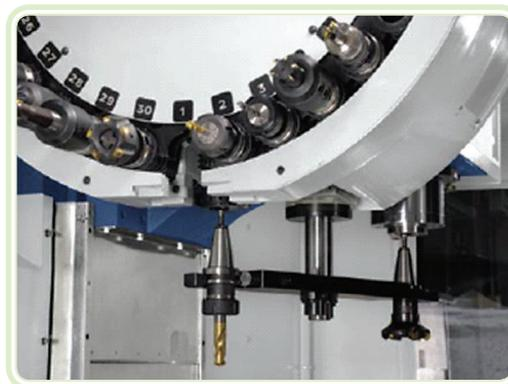
**Figura 5.8: Trocador automático de ferramentas**
