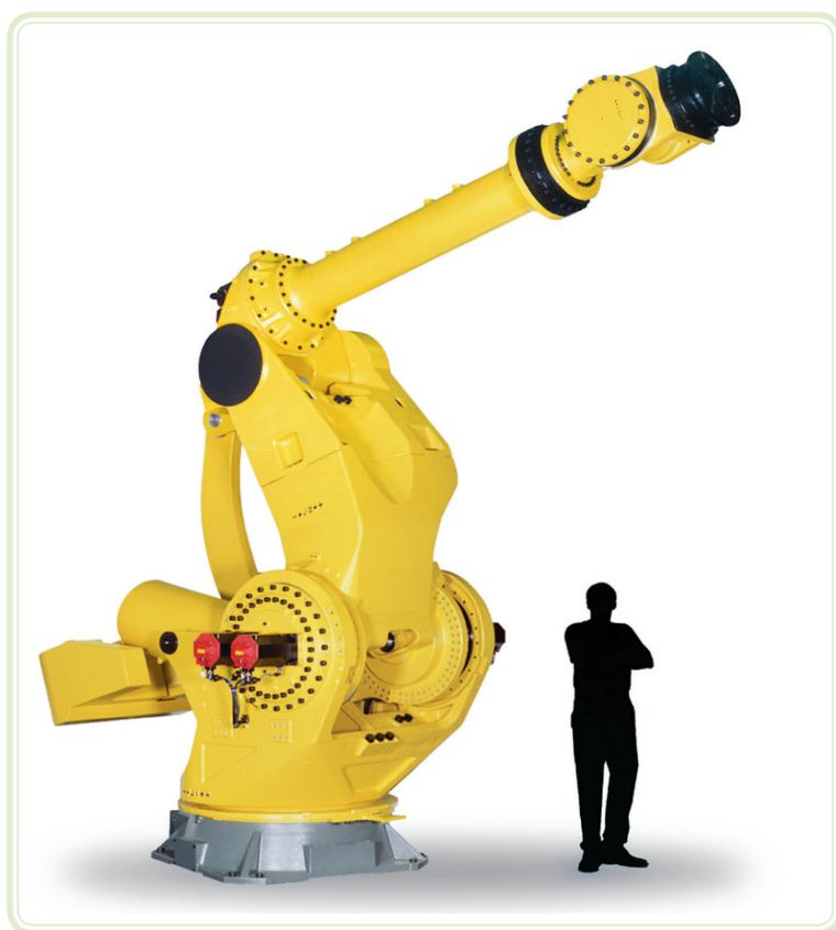
**Figura 4.6: Robô industrial com capacidade de carga de 1.200kg e alcance horizontal de 4,6m**
