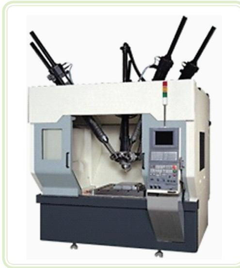
**Figura 5.3: Centro de usinagem "Hexapod" M-600V, produzido pela empresa Okuma**
